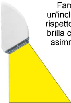
Faro lavoro con un'inclinazione di 45° rispetto alla superficie brilla con un fascio di asimmetrico di 60°.
